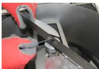
2 Aflojar el tornillo central del eje
