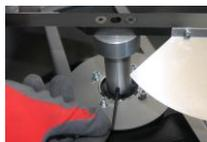
1 Aflojar el tornillo bloqueador del eje
