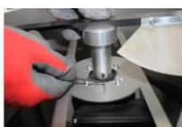
1 volver a apretar el tornillo bloqueador del eje
