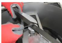
2 Aflojar el tornillo central del eje
