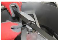
2 Aflojar el tornillo central del eje
